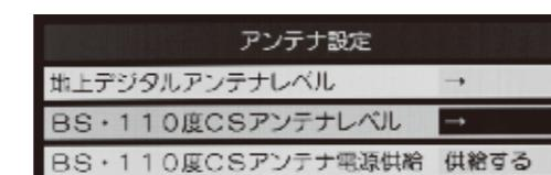
2. 『方向』ボタン▲▼で『BS・110度CSアンテナレベル』を選択し、『決定』ボタンを押します。
