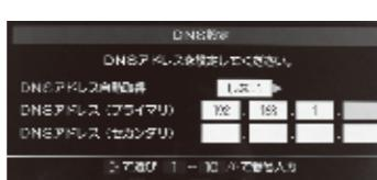
③方向ボタンで『DNSアドレス(プライマリ)』『DNSアドレス(セカンダリ)』をそれぞれ選び、『数字』ボタンで番号を入力します。※方向ボタン◀で訂正します。
