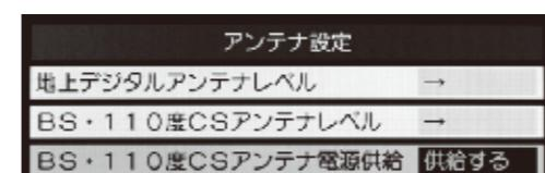
2. 『方向』ボタン▲▼で『BS・110度CSアンテナ電源供給』を選択し、『決定』ボタンを押します。
