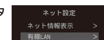
4. 左右ボタンで「IPアドレス自動取得」の「自動取得」を選びます。「接続」を選び、「決定」ボタンを押します。
