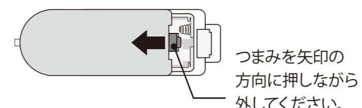
**2.電池の向きに注意して電池を入れ、カバーを元に戻します。**
