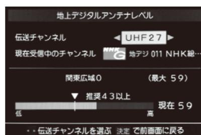
4. アンテナをゆっくり動かして「アンテナレベル」の数値が最大となるように調整します。
